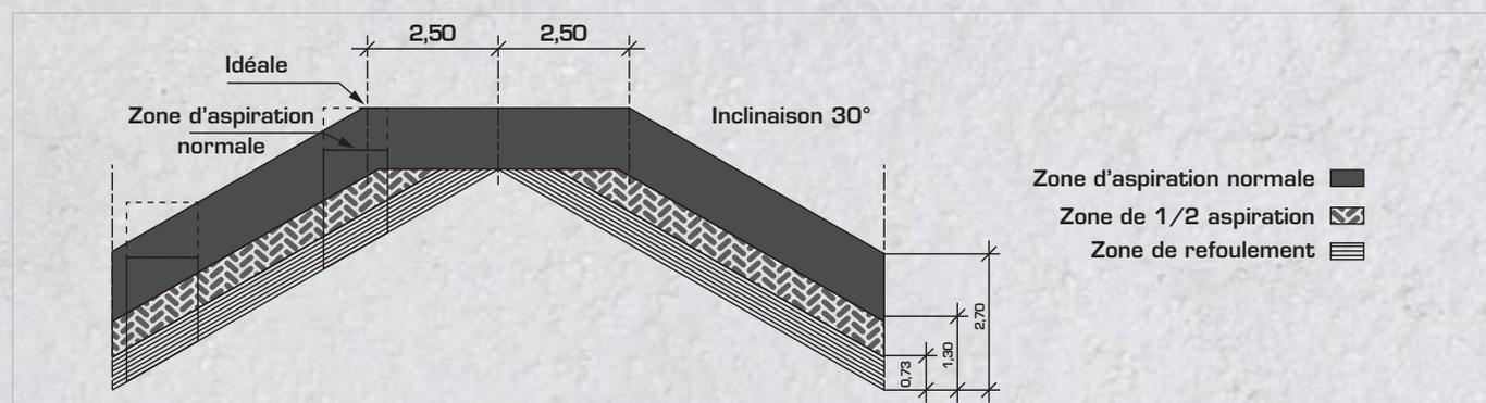
L'aspirateur **COTREK** évite le refoulement en prolongeant la cheminée jusqu'à la zone de demi-aspiration. Il profite alors de l'action du vent pour augmenter la dépression intérieure du conduit et réguler le tirage.
